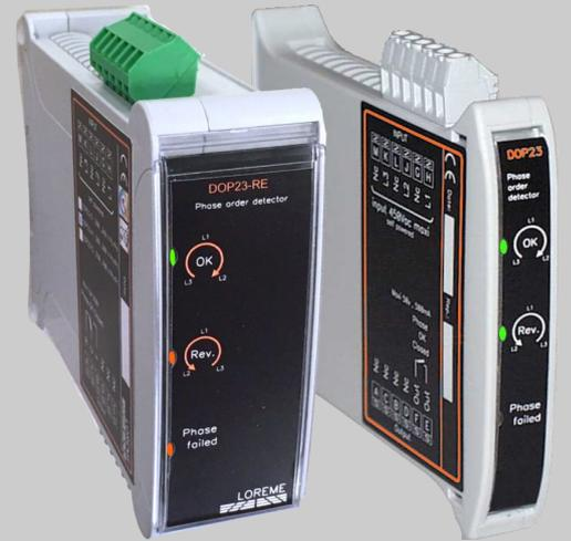
Le relais DOP23 permet le contrôle d'ordre des phases de système électrique triphasés pouvant être déplacés et dont le sens de rotation est important (par ex. Pompes, scies et perceuses). Un contact signalant l'ordre de phase correct et la présence de toute les phases est disponible pour autoriser la mise en service de l'installation. Des Led en face avant permettent un diagnostic facile (sens normale , inverse ou manque phase)
